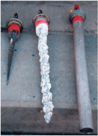
Magnesiumanodisauvoilla suojataan kuumavesisäiliöitä korroosiolta.
